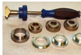
Systém BB30 má ložiska zalisovaná přímo v rámu a pro jeho montáž se používá speciální sada. Ložiska jsou však náchylnější k zanesení nečistotami.
