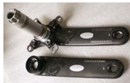
Nová středová složení umožňují použití osy většího průměru, která přinese vyšší tuhost. U některých klik je osa vyrobená z duralu, čímž se opět setří hmotnost.
