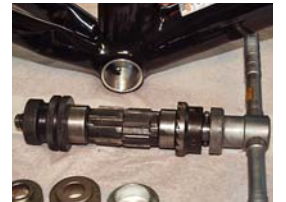
Systém BB30 má ložiska zalisovaná přímo v rámu a pro jeho montáž se používá speciální sada. Ložiska jsou však náchylnější k zanesení nečistotami.
