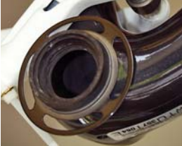
Porovnání středového pouzdra PressFit a klasického závitového sedlu.
