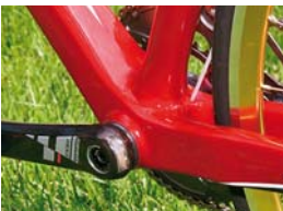
Středové složení PressFit má ložiska zalisovaná v miskách, podobně jako je tomu u hlavového složení.
