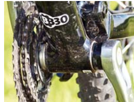
Porovnání středového pouzdra PressFit a klasického závitového sedlu.
